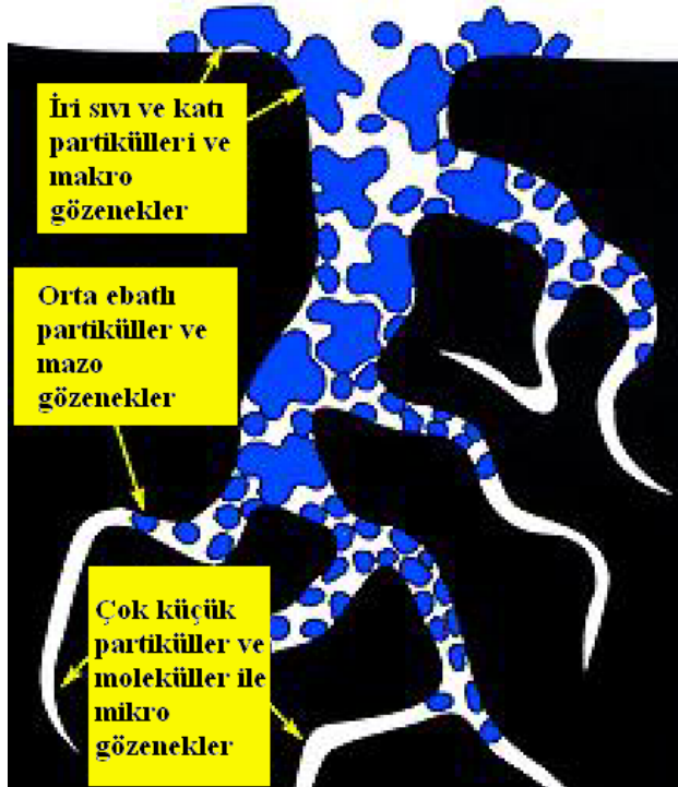
Şekil 2.5. Aktif karbon gözenek yapısı ve partikül tutma özellikleri
