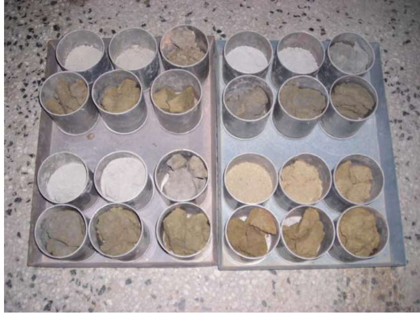
Şekil 3.18 Standart proktor deneyinin belirlenmesi için deneyden alınan numuneler
