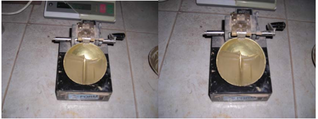
Şekil 3.7 Casagrande yöntemi ile likit limit deneyinde zemin birleşmeden önce ve sonraki durumu
