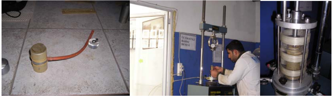
Şekil 3.28 Numune kalıbından çıkarılmış numunelerin üç eksenli basınç deneyine hazırlanması
