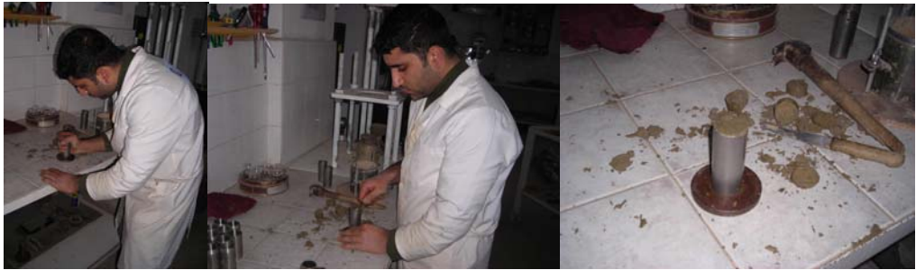
Şekil 3.26 Üç eksenli basınç deney numunesinin hazırlanması
