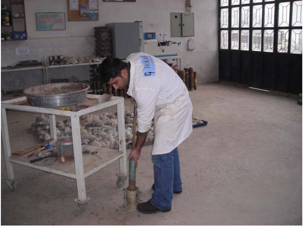
Şekil 3.24 Proktor sıklılığında deney numunesinin hazırlanması
