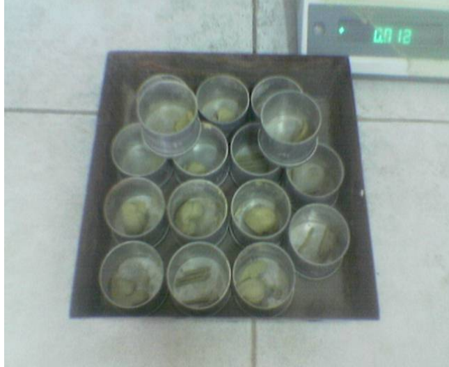
Şekil 3.9 Likit limitin ve plastik limitin belirlenmesi için deneylerden alınan numuneler
