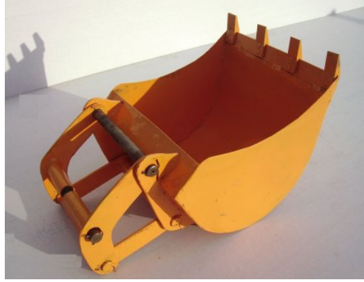
Şekil 3.16. Kazma hareketi sağlayan kepçe yardımcı uzuvlarıyla montaj halinde
