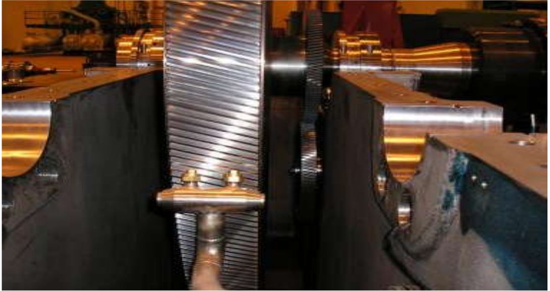
Şekil 3.29. Hava kompresörü bull gear montaj şekli
