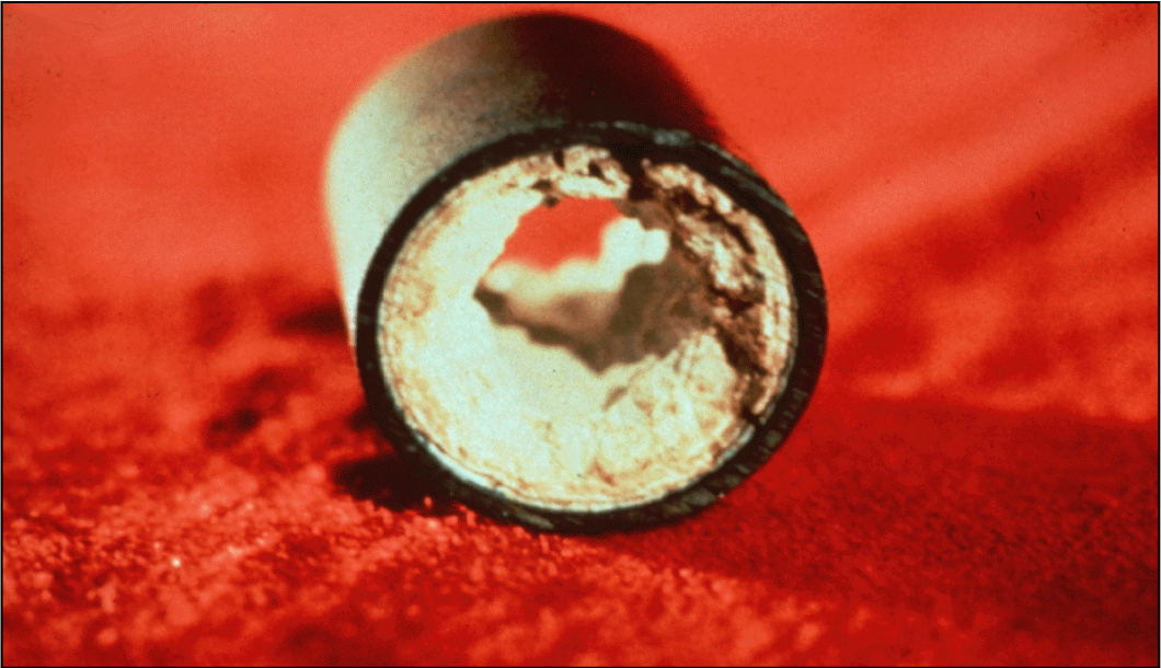
Şekil 3.47. Borudaki kışır oluşumu
