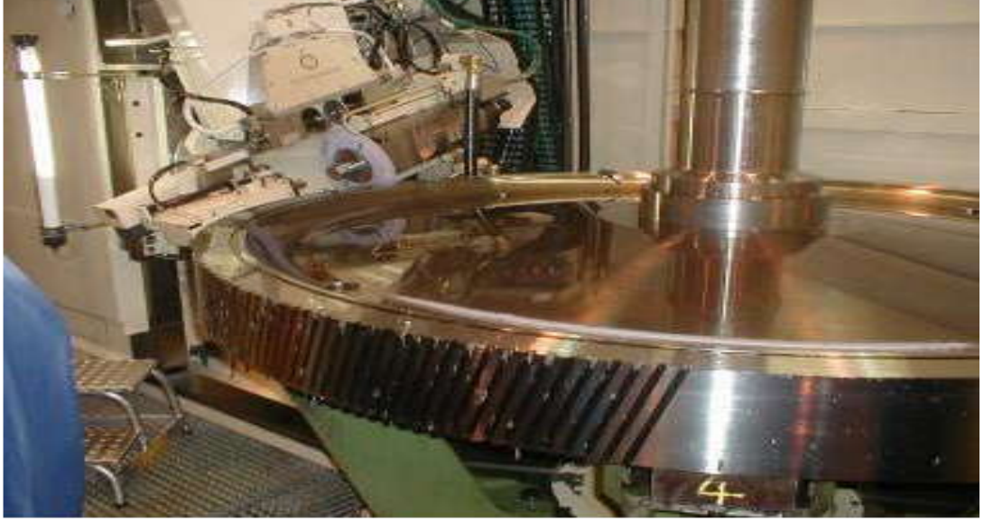
Şekil 3.28. Hava kompresörü ana dişli işlenme şekli
