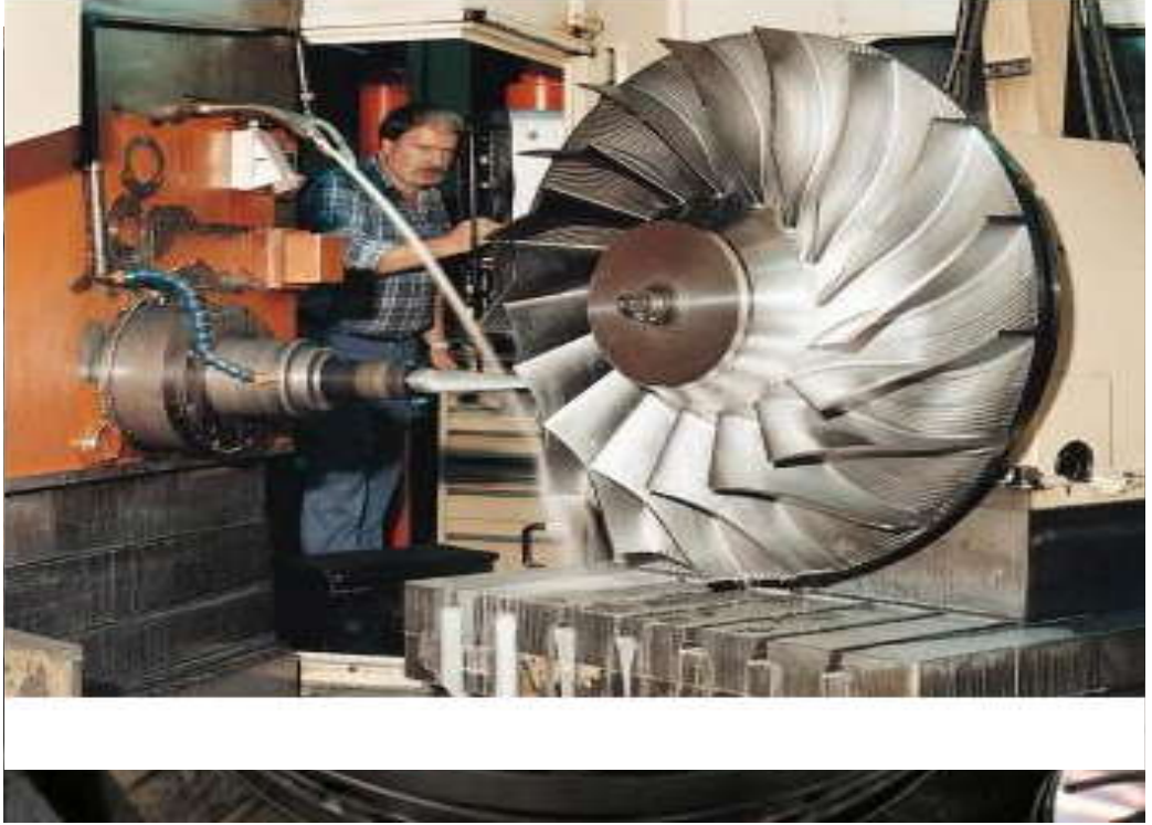
Şekil 3.27. Hava kompresörü milled kanatçık işlenme şekli
