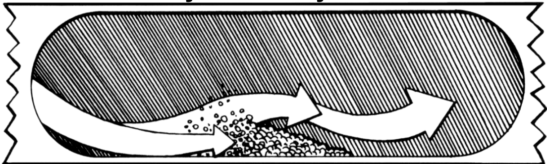
Şekil 3.55. Birikinti oluşmuş bir borunun temizlenmesi
