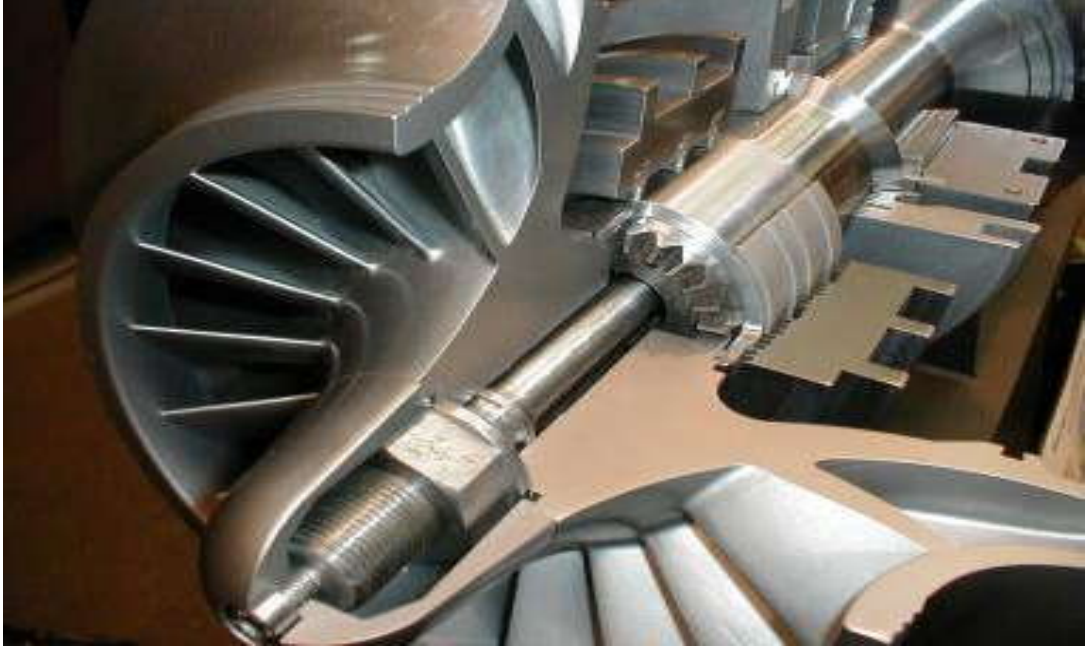
Şekil 3.30. Hava kompresörü iç yapısı (Eksenel kanatçık,yataklar)
