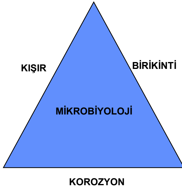
Şekil 3.45. Soğutma kulesi mikrobiyolojik üreme neden şeması
