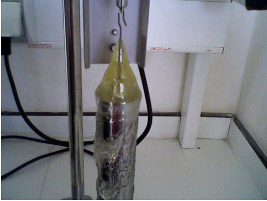
Şekil 4.11. DEAE-D/ECH ikili sisteminin tepkimesinde jelleşme noktasının gözlenmesi.
