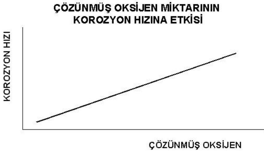
ŞEKİL 2.7. ÇÖZÜNMÜŞ OKSİJEN MÜKTARININ KOROZYON HIZINA ETKİSİ
