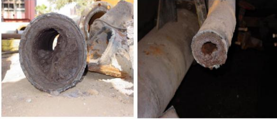
ŞEKİL 4.5. MODERNİZASYON ÖNCESİ, 3.YÜKSEK FIRIN GAZ YIKAMA SİSTEMİ BORU VE VANALARI
