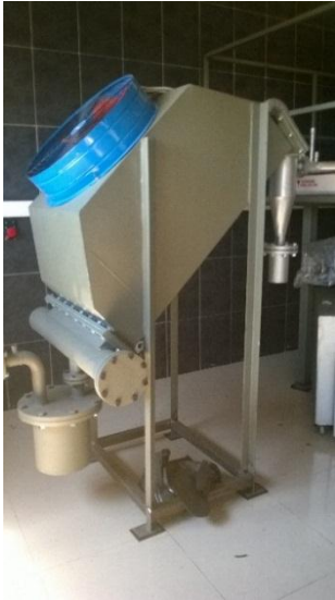
Şekil 3. 13. Gaz soğutma ünitesi genel ve alttan (serpantinli borular) görünüşleri
