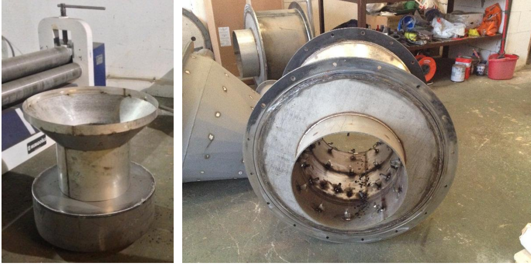
Şekil 3. 7. İmalat aşamasındaki reaktör ana gövdesi (AISI 310)
