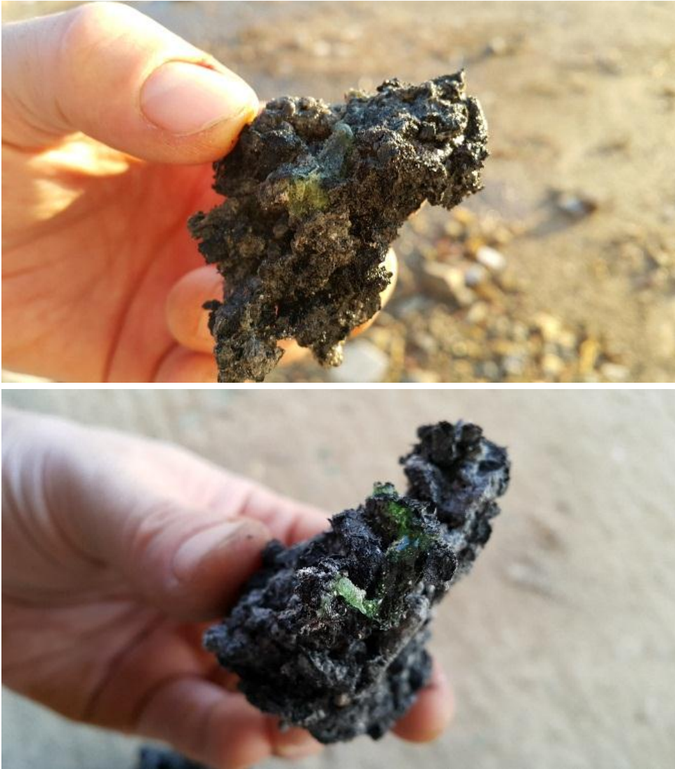
Şekil 4. 8. Deney sonunda içinde camsı yapı görülen aglomerasyon (topaklaşma) oluşumu
