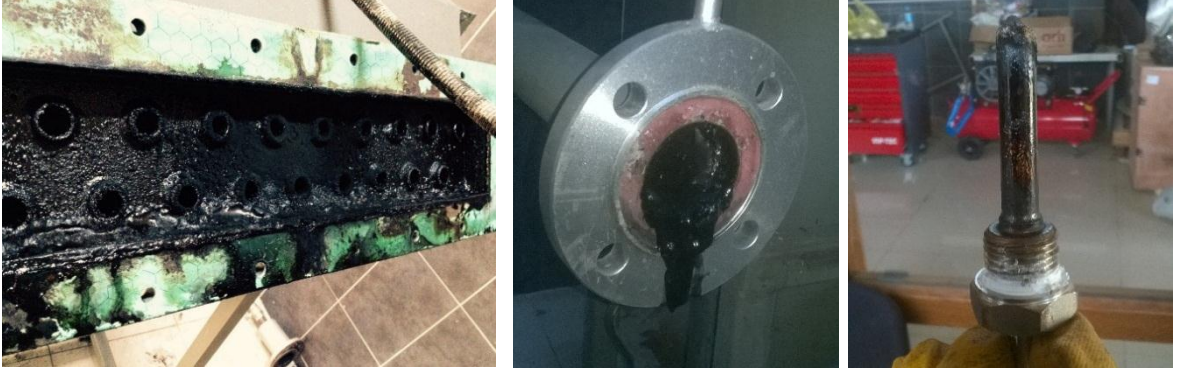
Şekil 4. 7. Düşük sıcaklıklarda yoğuşma ve katran oluşumunun sistem elemanları üzerinde yarattığı kirlilik
