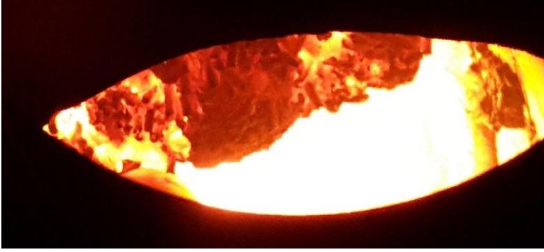
Şekil 4. 9. Reaktör içinde bloklanma
