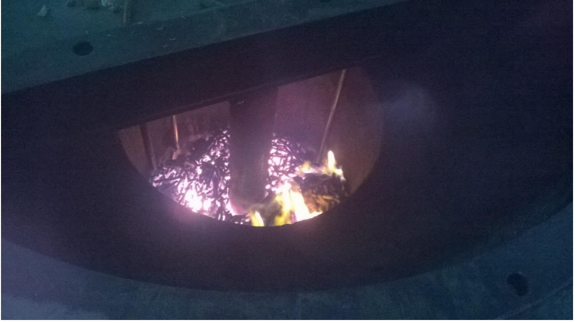
Şekil 3. 23. Deneme sonu (Kor biyokütle yakıtın üst seviyesine ulaşmış)
