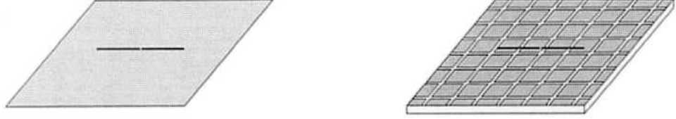
Şekil 2.12. Dipol anten denemeleri, a) Dipol anten PEC ve PMC üzerinde, b) Diplo anten HIGP üzerinde.
