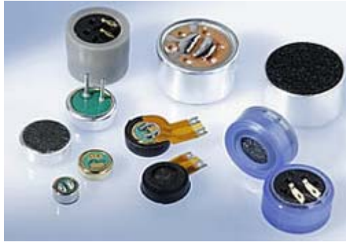
Şekil 3.4. Elektret mikrofonun parçaları.
