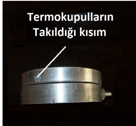
Şekil 3.24. Kalıbın üstten görünüşü
