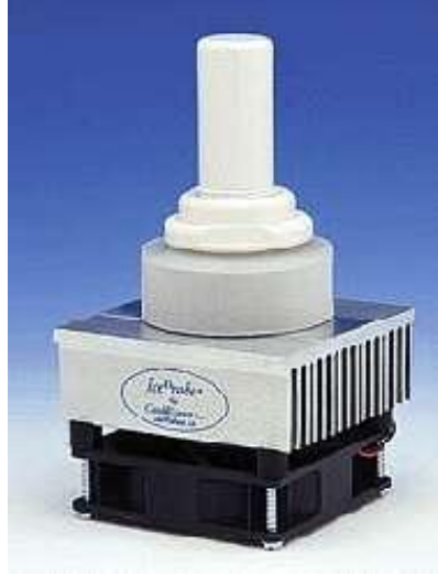
Şekil 3.17. 50W Soğutma gücünde bir buz sondası
