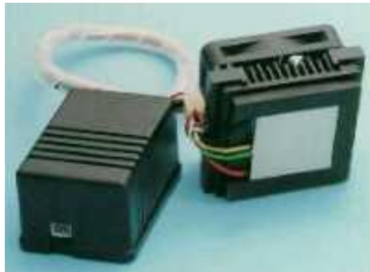
Şekil 3.16. Termoelektrik CPU Soğutucusu ve DC Besleme Ünitesi
