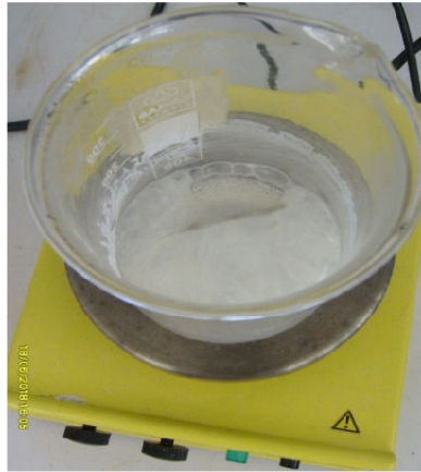
Şekil 3.5 400 °C'de jelleşmeye başlayan numune.
