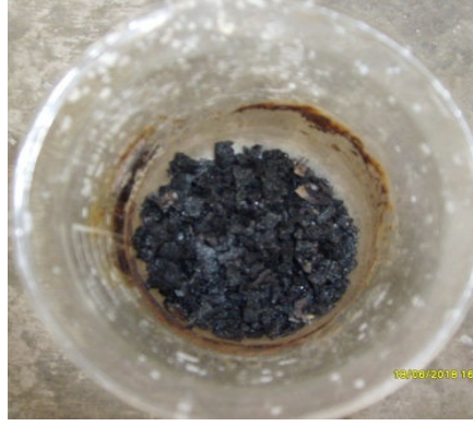
Şekil 3.6 Mantolama işlemi sonrası kömürleşen numune.
