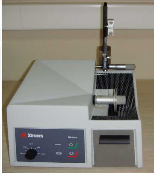
Şekil 3. 18 Hassas numune kesme cihazı.
