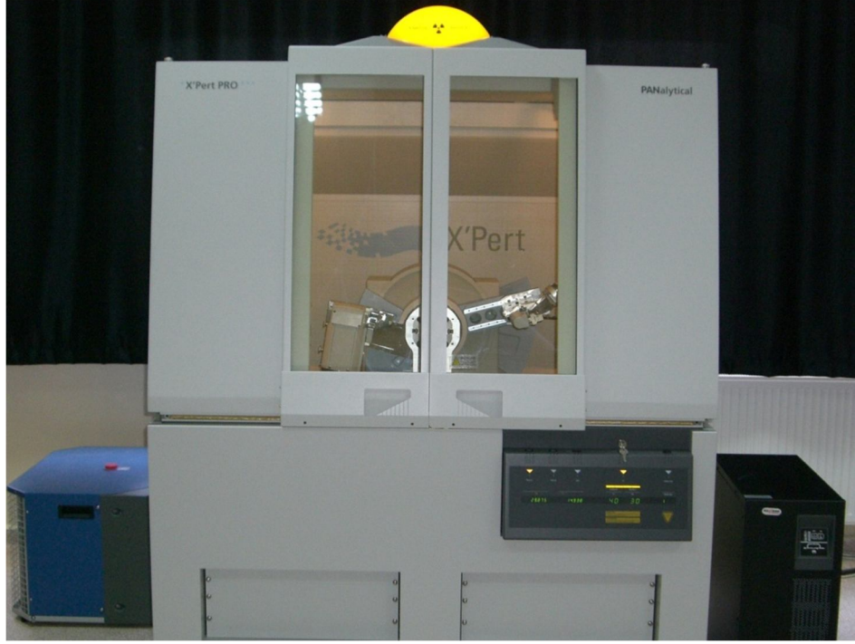
Şekil 3.17. K.S.Ü Fen Edebiyat Fakültesi araştırma laboratuvarı XRD Cihazı
