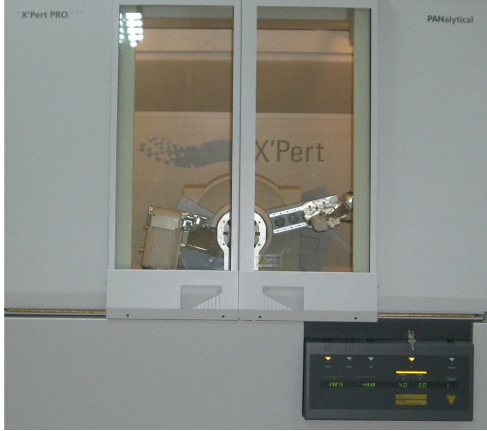
Şekil 3.7. Üretilen filmlerin yapısal karakterizasyonunda kullanılan X-ışını difraktometresi (Philips X'pert Pro X-ışını difraktometresi Cu K \alpha , \lambda=1.540056 \text{ \AA} )
