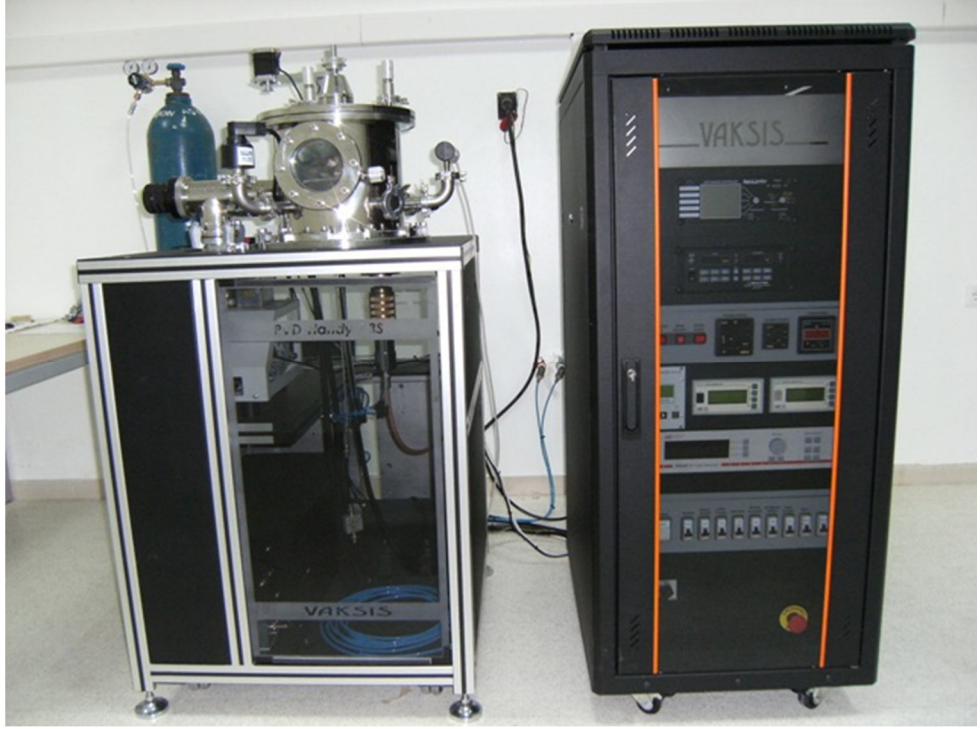
Şekil 3.4. Fiziksel Biriktirme Sistemi (PVD-Handy/3S)
