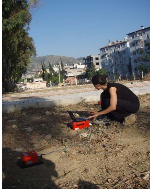
Şekil 4.2. Mikrotremor ölçümü için kullanılan SYSCOM marka sismometre ve ölçüm alma düzeneği
