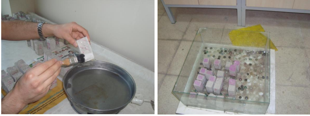
Şekil 3.6. Kapilerite Deneyi. (1) Numuneye Parafin Sürülüyor, (2) Numunenin alttan su alması sağlanıyor.
