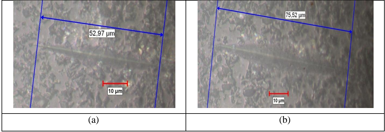
Şekil 4. 2 A5Z numunesinin a) 4.9 N b) 9.8 N yükteki izleri.
