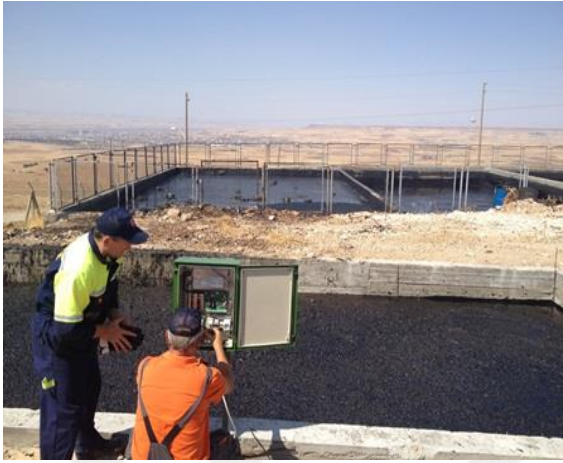
Şekil 4.32 Petrol üretim tank dibi slaçlarının elektrokinetik yöntem ile bertarafı pilot çalışması
