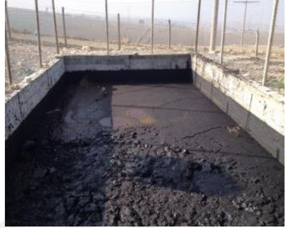
Şekil 4.32 Petrol üretim tank dibi slaçlarının elektrokinetik yöntem ile bertarafı pilot çalışması
