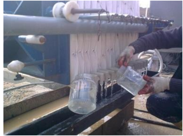
Şekil 4.33 Petrol/Doğalgaz sondaj atık bertarafı pilot çalışma
