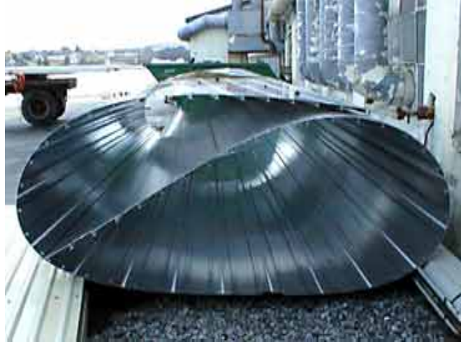
řekil 2.3. Yksek hız feribotlarında kullanılan alminyum ekstrzyon panellerinin srtnme karıřtırma kaynađı ile birleřtirilmesi (am, 2003)
