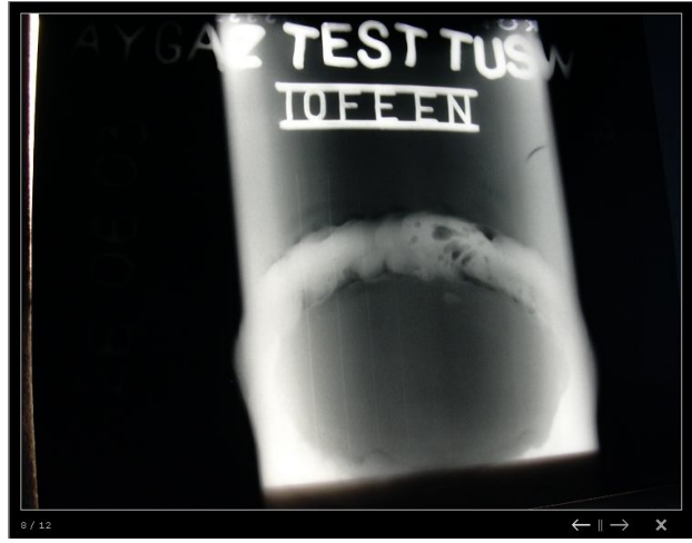
Şekil 3.4.2. Radyografide görüntü kalite belirtecinin görünümü (Anonim, 2001).
