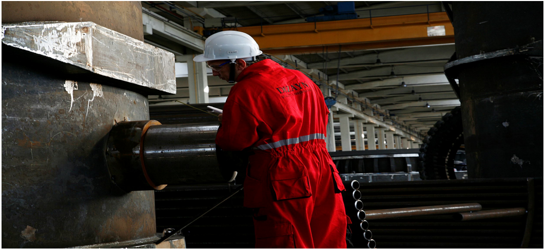
Şekil 3.2.1. NDT uygulamalarından önce gözle muayenenin yapılması (Anonim, 2008 Dizayn Kalite Mühendislik arşivleri , İstanbul)
