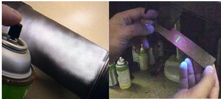
Şekil 3.2.7. Flor ışıl penetrantla muayene yapılan malzemenin incelenmesi (Anonim, 2000 Flor ışıl penetrant http://www.yilbak.com/ )
