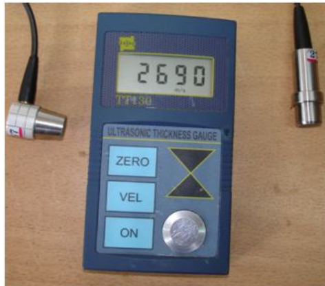
Şekil 3.5.2. Ultrasonik kalınlık ölçüm cihazı (Anonim, 2000)
