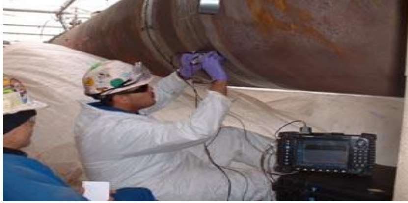
Şekil 3.10.5. TOFD muayene yönteminin uygulaması (Anonim, 2010)
