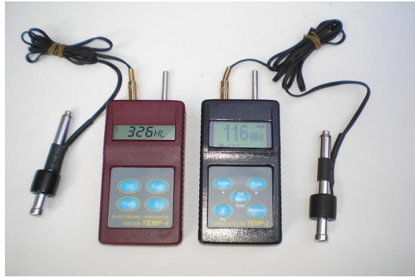
Şekil 3.9.1. Tahribatsız sertlik ölçüm cihazı (Anonim, 2004).
