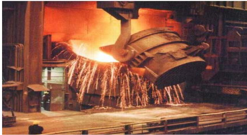
Şekil 4.5. Konvertere pik demir şarjı (Anonim, 2011)
