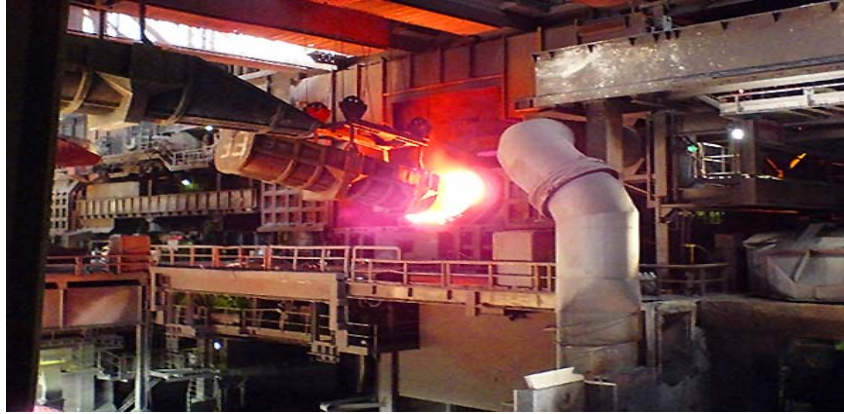
Şekil 4.4. Konvertere hurda şarjı (Anonim, 2011)
