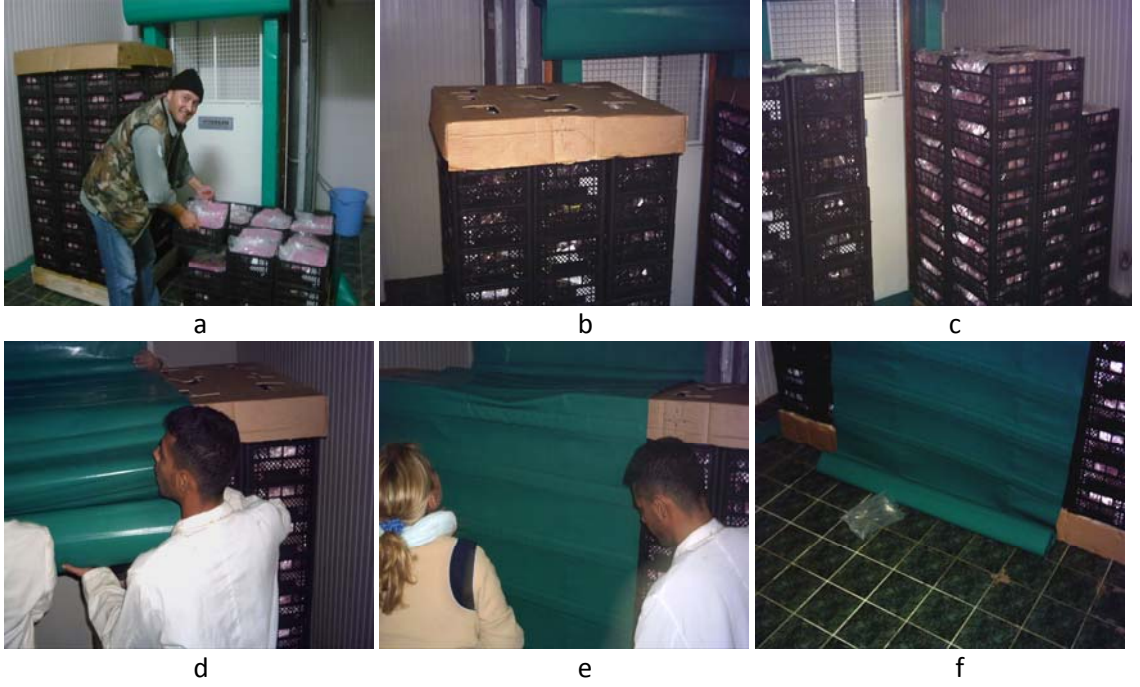
Şekil 3.6. 2008 ve 2009 yıllarında paketlenen üzümde zorlanmış hava ile önsoğutma (a-c:Kasaların paletlere yerleştirilmesi d-f:Brandanın serilmesi).
