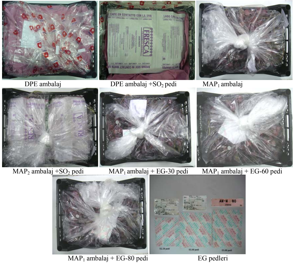
Şekil 3.2. Çalışmada kullanılan ambalaj materyalleri, SO 2 ve EG pedleri
