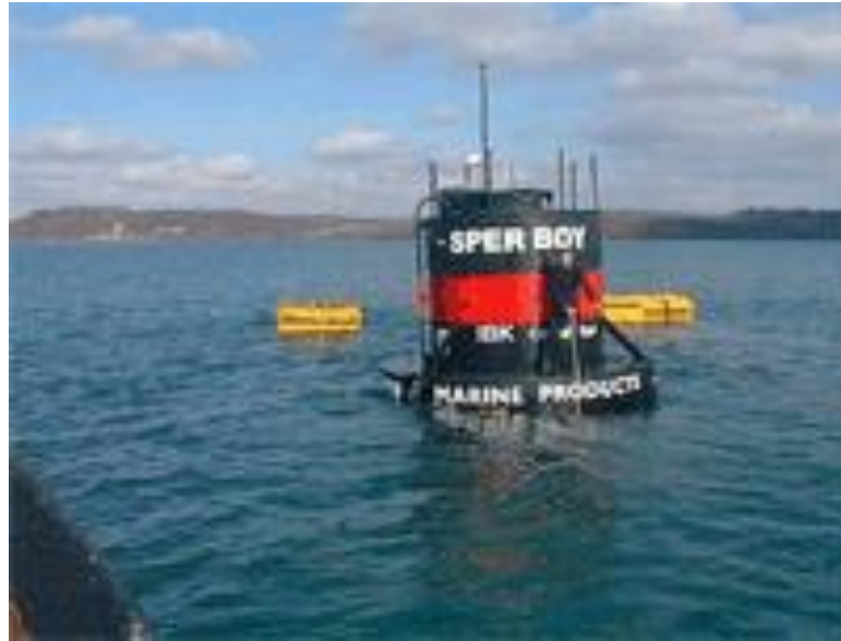
Şekil 2. 112. Açık denizde konuşlandırılan ve test edilen 1/5 ölçekli pilot ünite
