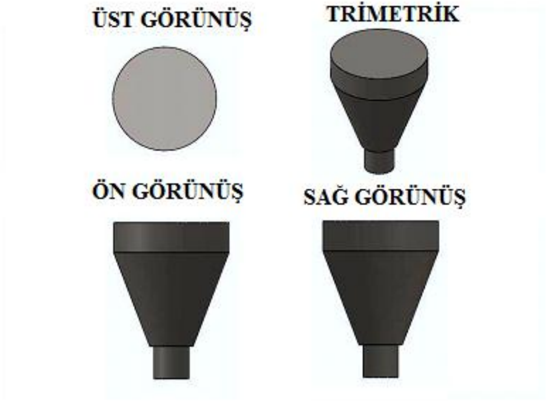
Şekil 2. 167. PowerShape 2011 öğrenci sürümünde yapılan çizimlerden alınan görüntülerle Frog Form 1'e ait ön, üst, sağ yan ve trimetrik görünümle
