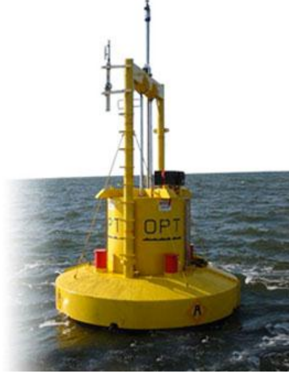
Şekil 2. 89. Okyanusta test edilmekte olan bir OPT (Anonymous, 2010i)
