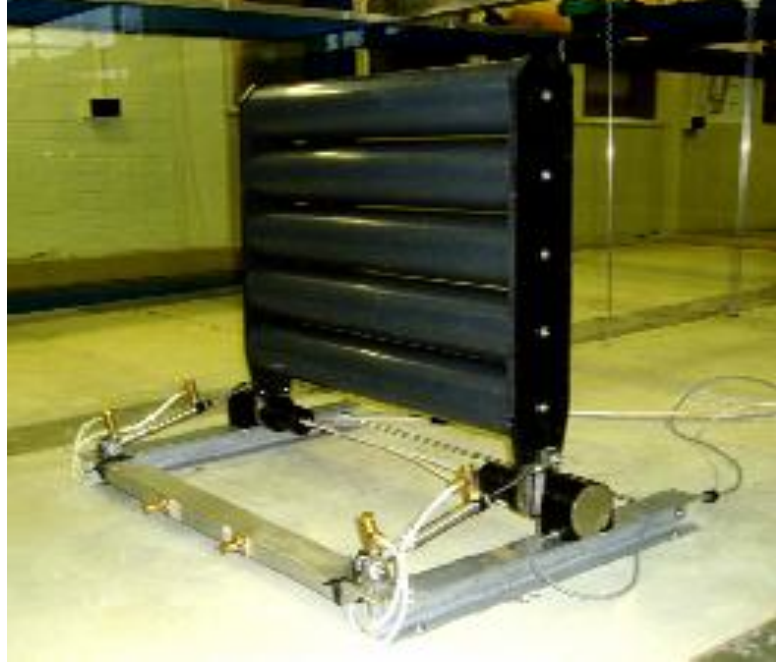
Şekil 2.46. Northen'de test edilen 1/20 ölçekli Oyster protitipi (Queen's University Belfast, 2007)
