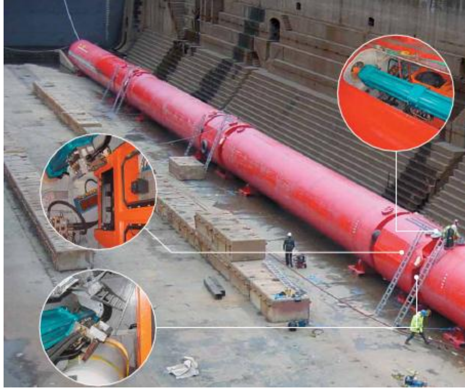
Şekil 2. 66. Pelamis'in bükülen kısımlarının iç kesit görüntüleri ve içeriği (Anonymous, 2010g)
