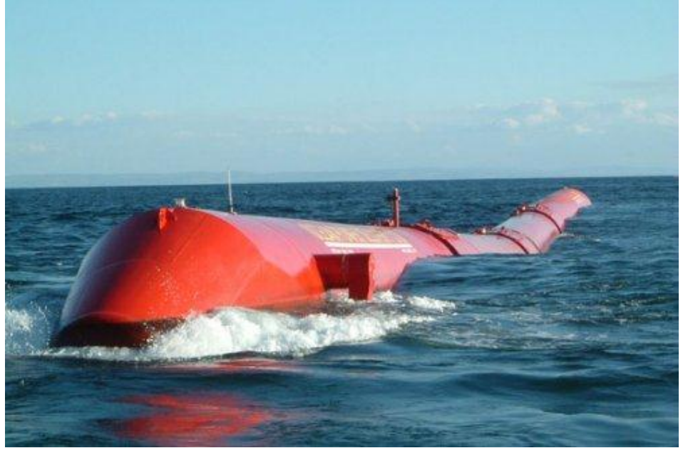
Şekil 2. 64. Pelamis'in denizdeki kıvrımlı görüntüsü (Anonymous, 2010g)
