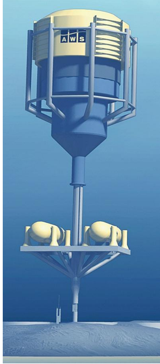
Şekil 2. 102. Archimedes Wave Swing (AWS) sisteminin şematik görünümü (Anonymous, 2010j)
