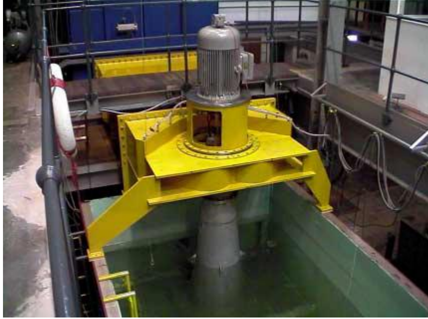
Şekil 2. 83. Wave Dragon modeline ait test standında test edilmekte olan türbin (Tedd, 2007)
