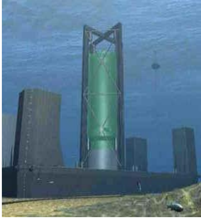
Şekil 2. 103. Arşimet Dalga Salınımı sisteminin deniz dibindeki yapısının şematik olarak gösterimi (Anonymous, 2010k)
