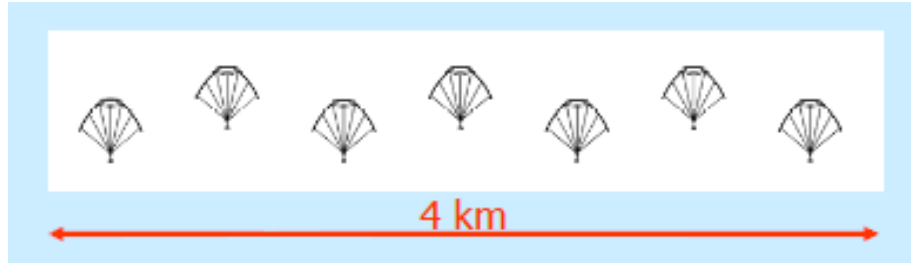
Şekil 2. 88. Wave Dragon güç üretme planı (Soerensen, 2006)
