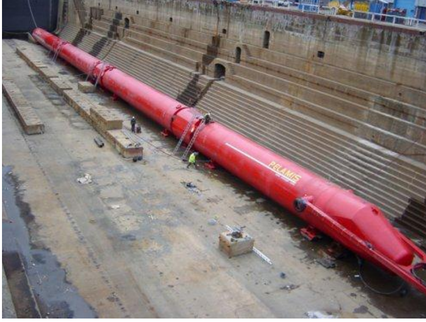
Şekil 2. 62. Pelamis'in kuru havuzdaki görüntüsü (Anonymous, 2010g)
