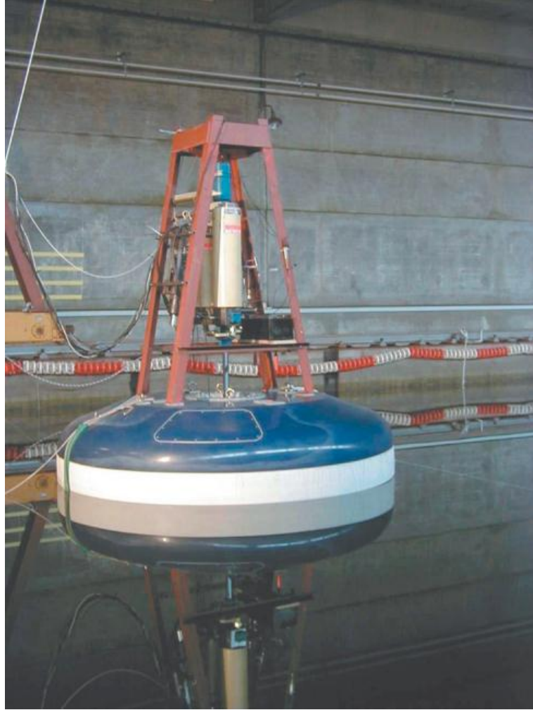
Şekil 2. 122. Nokta absorblayıcı dalga enerji konvertörüne ait test edilmiş olan 1/10 ölçekli prototip (Anonymous, 2010p)
