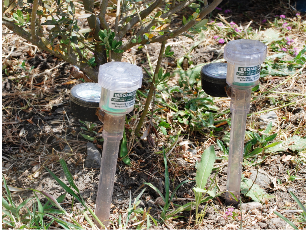
Şekil 3.11. Deneme parcelinde ağaçların taç izdüşümleri içinde toprağa yerleştirilmiş olan tansiyometreler
