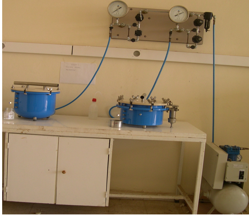
Şekil 3.3. Toprak rutubet karakteristlik verilerinin saptanmasında kullanılan basınçlı plaka sistemi
