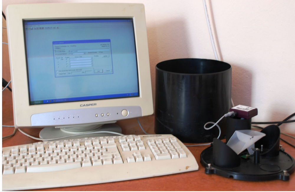
Şekil 3.13. Denemede kullanılan yağışölçerin veri toplama ünitesindeki bilgilerin bilgisayara aktarılması
