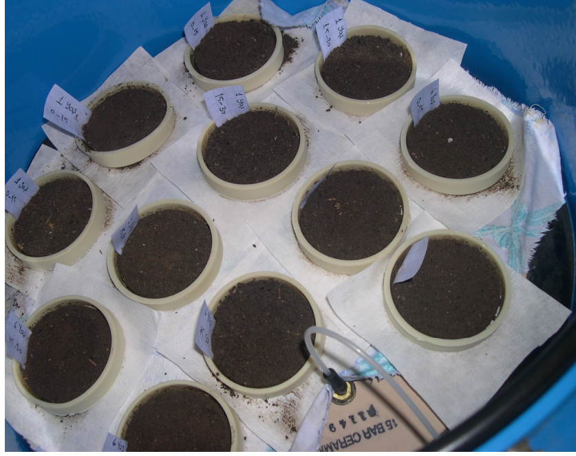
Şekil 3.4. Bozulmuş toprak örneklerinin basınç uygulanmadan önce seramik tablalar üzerindeki görünümü
