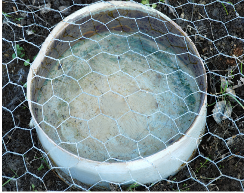
Őekil 3.10. Deneme alanında mikrolizimetrelerin yakınına yerleřtirilmiř olan buharlařma kabının űstten grnm
