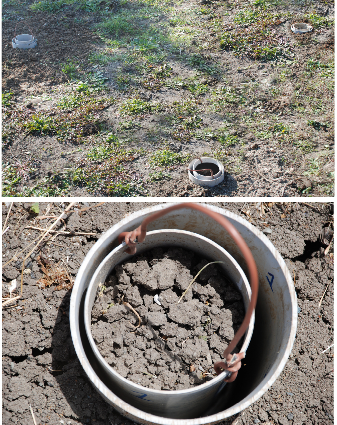
Şekil 3.9. Mikrolizimetrelerin bir parseldeki 3 paralelli yerleşimi ve yakından görünümü
