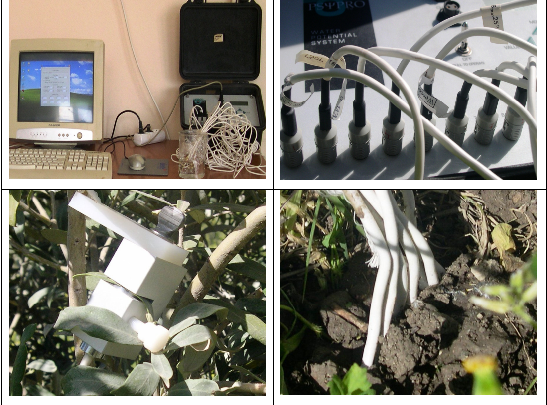
Şekil 3.14. Psikrometre sensörlerinin laboratuvarındaki kalibrasyonu, arazi koşullarında cihazın kurulumu, yaprak ve toprak su potansiyellerinin ölçümü
