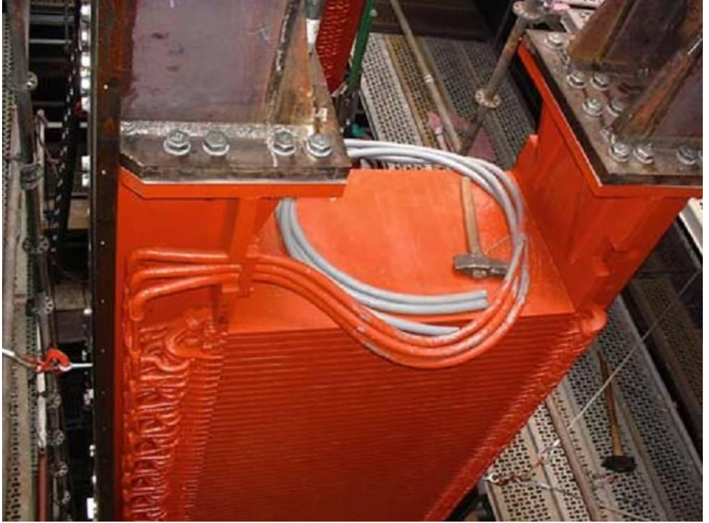
Şekil 2.101. AWS'nin 2MW'lık prototipinde kullanılan lineer jeneratör (Cruz, 2008)
