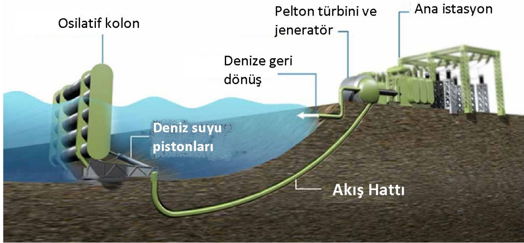
Şekil 2.67. Oyster dalga enerjisi konvertörü ve yapısı ve çalışması (Folley, 2008)
