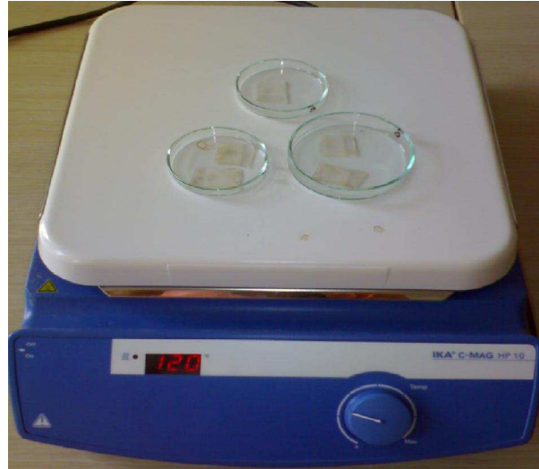
Şekil 17. Üretilen TiO 2 ince filmler ve hot plate cihazı kullanılarak yapılan ön tavlama işlemi
