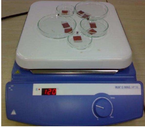
Şekil 23. P3HT ile kaplanan numunelerin tavlanması
