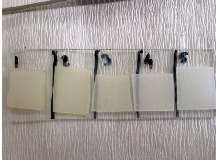
Şekil 19. Soldan sağa 350, 400, 450, 500 ve 550 °C’de 30 dakika tavlanan TiO 2 ince film kaplamalar
