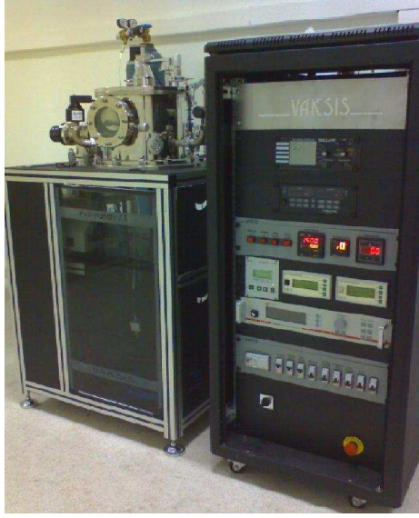
Şekil 25. Vakumlu termal buharlaştırıcı cihazı ile Al kontak kaplama işlemi
