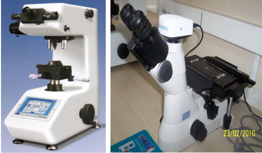
Şekil 3.3. Statik sertlik deneyleri için kullanılan a) Future-Tech FM 700 mikrosertlik cihazı b) Nikon MA 100 metal mikroskobu
