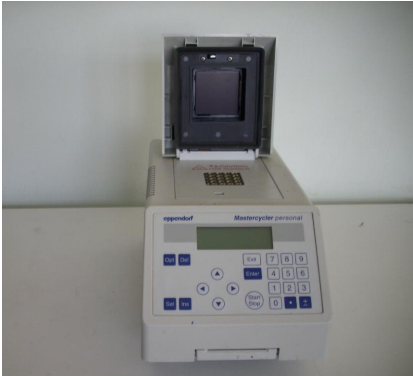
Şekil 3.4. Araştırmada 16S rRNA geninin çoğaltılmasında kullanılan PCR cihazı
