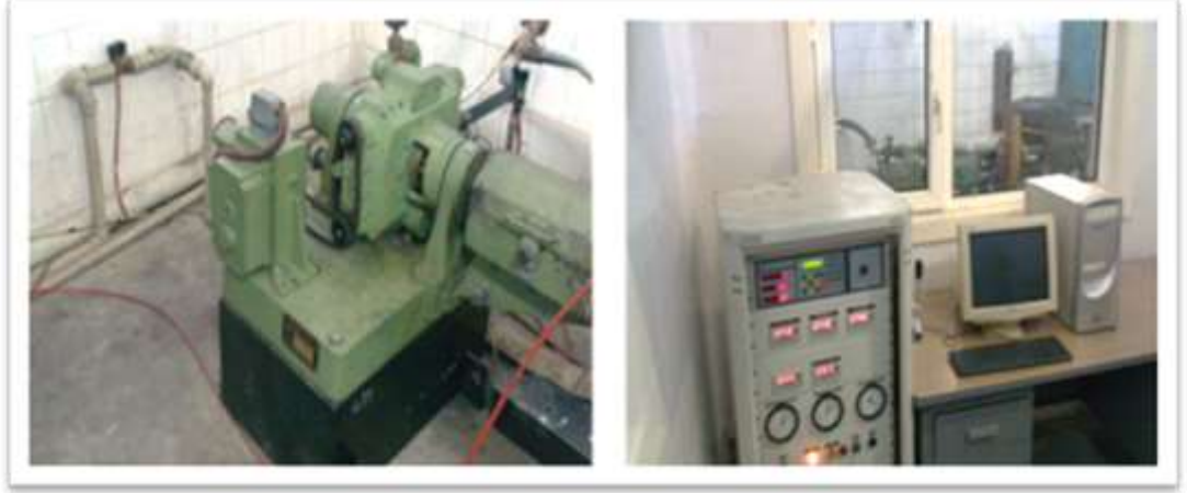
Şekil 3.3. BT 190 tipi hidrolik dinamometre ve kontrol paneli
