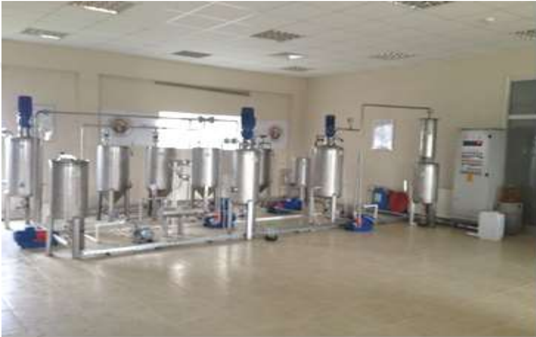
Şekil 3.7. Karadeniz tarımsal araştırma enstitüsü biyodizel üretim reaktörü
