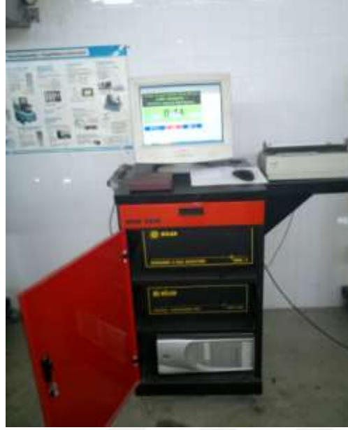
Şekil 3.6. Mod 2200 egzoz emisyon gaz analizi cihazı
