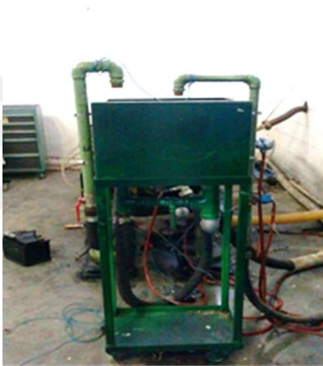
Şekil 3.5. BT 190 hidrolik dinamometre kullanılan soğutma kulesi
