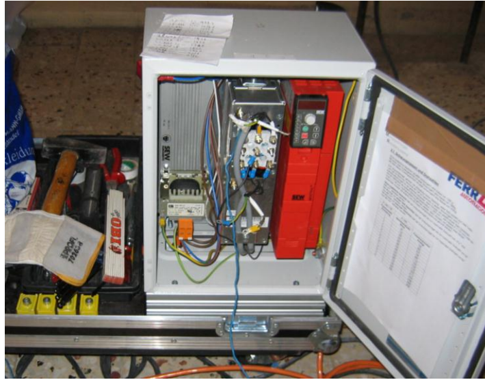
Şekil 3.4. Titreşim Üreticinin Kontrol Ünitesi
