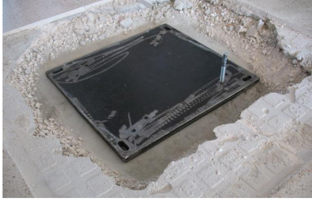
Şekil 3.5. Titreşim üreticinin monte edildiği çelik plaka
