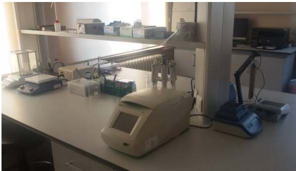
Şekil 3.9. Moleküler çalışmada kullanılan PCR ve elektroforez cihazı
