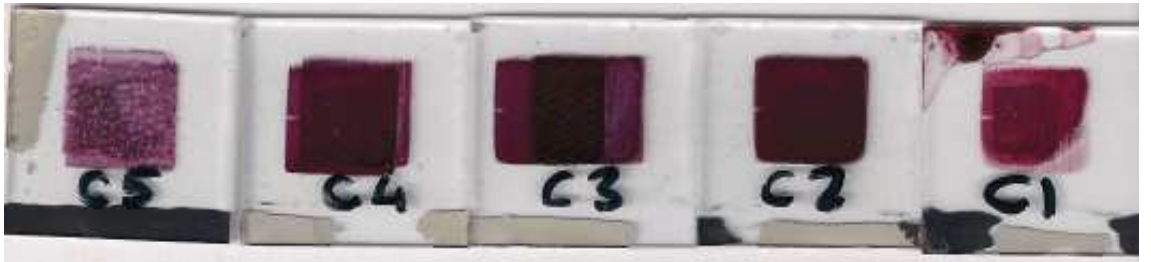
Şekil 4.10. Screen printing yöntemi ile kaplanmış P3HT:PCBM katmanların görüntüsü
