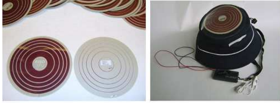
Şekil 2.2. Screen printing yöntemi ile seri bir şekilde üretilmiş güneş pili modülleri (Krebs ve ark., 2009)
