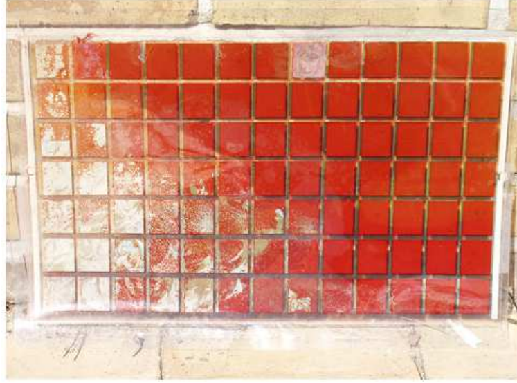
Şekil 2.1. 0.1 m 2 yüzey alanına sahip organik güneş pilinin dış ortam şartlarında test edilmesi (Krebs ve ark., 2007).
