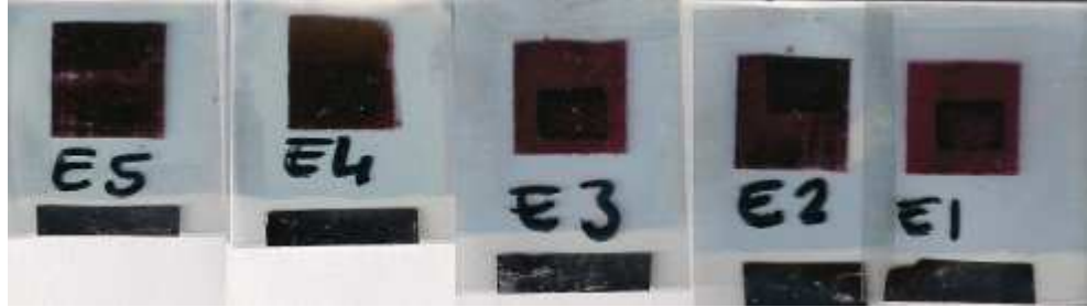
Şekil 4.25. PET/ITO/PEDOT:PSS/P3HT:PCBM/Al yapıda üretilen güneş pilleri
