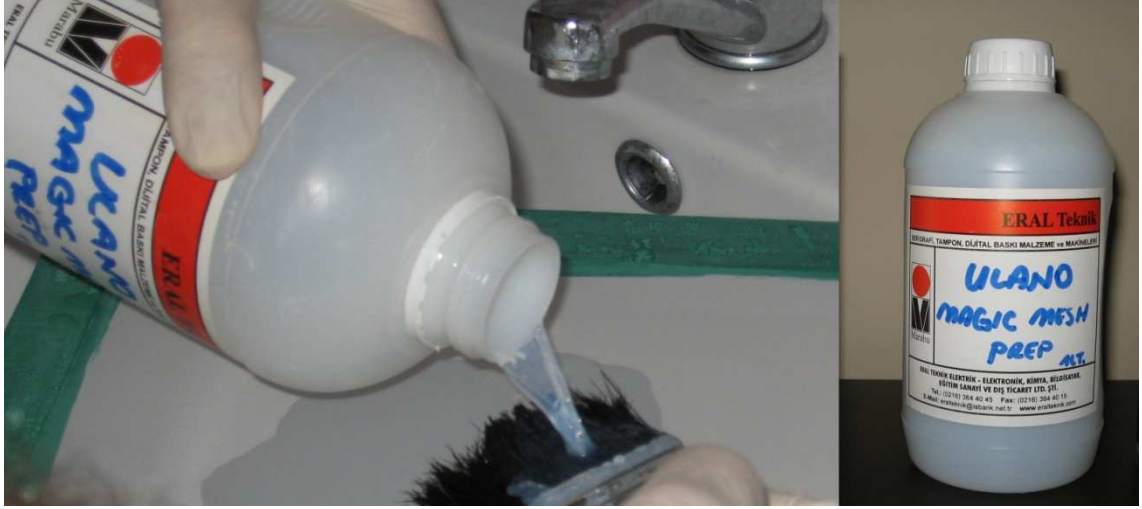
Şekil 3.10. Ulano firmasının ürünü olan Magic Mesh Prep temizleyici sıvısının ekran üzerinde uygulanması
