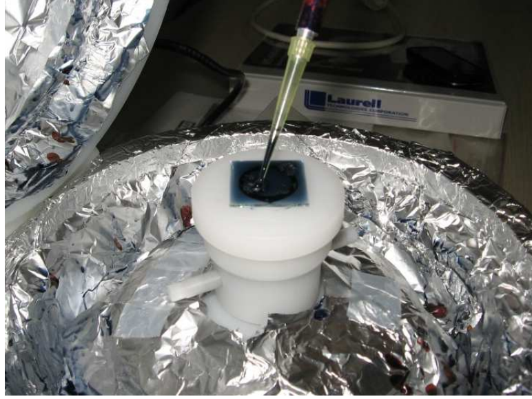
Şekil 4.9. PEDOT:PSS'in spin-coating yöntemi ile kaplanması
