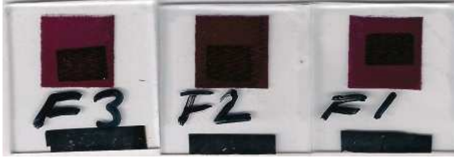
Şekil 4.30. CAM/ITO/PEDOT:PSS/P3HT:PCBM/Al yapıda üretilen güneş pilleri
