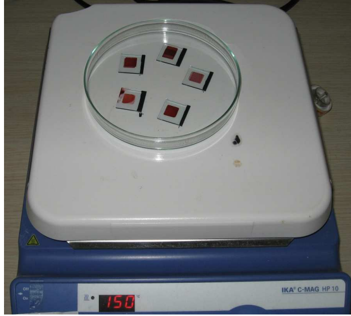
řekil 4.12. P3HT:PCBM ile kaplanmış numunelerin tavllanması
