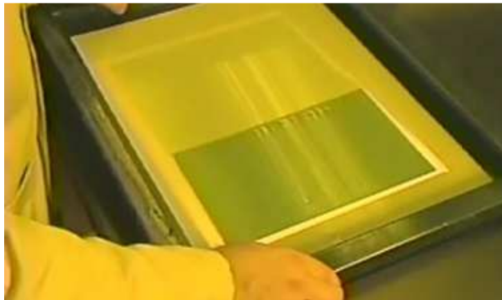
Şekil 3.11. Ulano CDF ışık duyarlı emülsiyonun ekrana uygulanması (Ulano)
