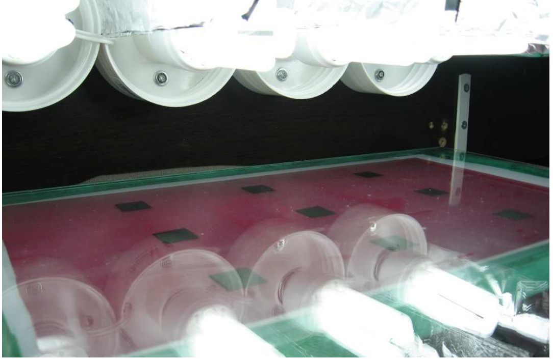
Şekil 3.12. UV ışık yayan bir kaynak altında emülsiyonun pozlanması
