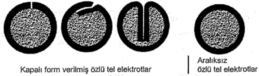
Şekil 3.9. Özlü tel elektrotlarda yaygın olarak kullanılan kesit formları (Fischer ve Baum, 1977).
