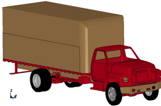
Şekil 3.5. 10000 kg ağırlığındaki kamyonun sonlu elemanlar modeli (NCAC, 2008)
