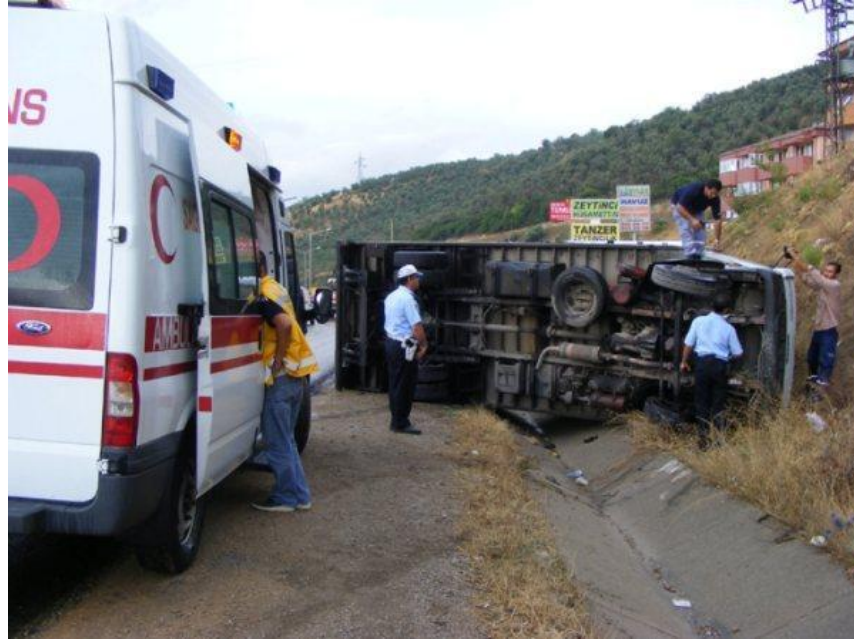
Şekil 1.4. 2m genişlik ve 3Y:1D eğimli drenaj kanalına girerek devrilen ağır tonajlı araç
