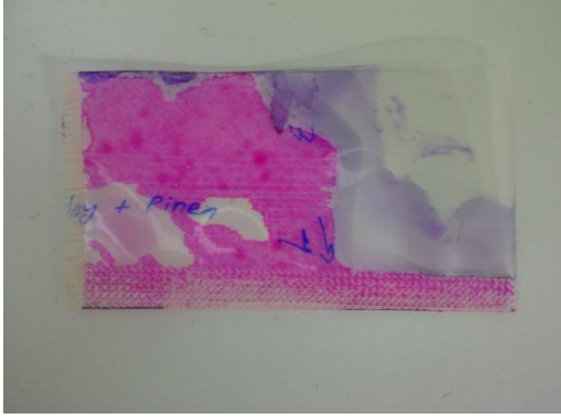
Şekil 4.2.Sızdıran torba ambalaj kaynağına örnek
