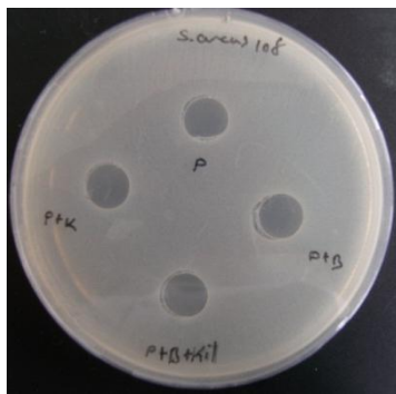
Şekil 4.6. Nanokompozit filmin S. aureus ATCC 25923 üzerindeki antimikrobiyal aktivitesi: (1) poli-beta-pinen içermeyen naturel PP film (kontrol), (2) poli-beta-pinen içeren PP film, (3) nanokil içeren PP film (kontrol), (4) poli-beta-pinen+nanokil içeren PP film.
