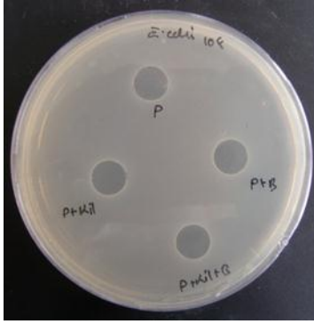
Şekil 4.4. Nanokompozit filmin E. coli ATCC 25922 üzerindeki antimikrobiyal aktivitesi: (1) poli-beta-pinen içermeyen naturel PP film (kontrol), (2) poli-beta-pinen içeren PP film, (3) nanokil içeren PP film (kontrol), (4) poli-beta-pinen+nanokil içeren PP film.
