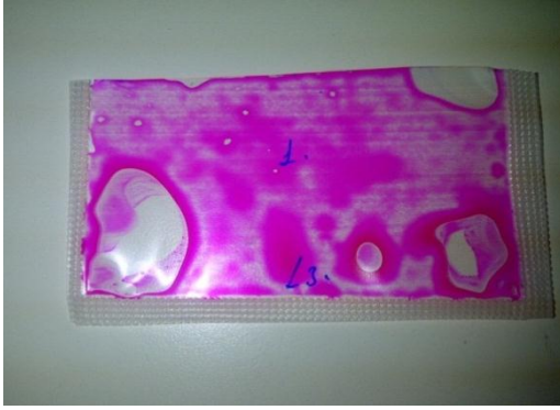
Şekil 4.3. Sızdırmayan torba ambalaj kaynağına örnek
