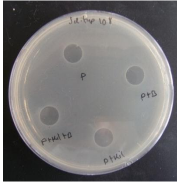
Şekil 4.4. Nanokompozit filmin E. coli ATCC 25922 üzerindeki antimikrobiyal aktivitesi: (1) poli-beta-pinen içermeyen naturel PP film (kontrol), (2) poli-beta-pinen içeren PP film, (3) nanokil içeren PP film (kontrol), (4) poli-beta-pinen+nanokil içeren PP film.
