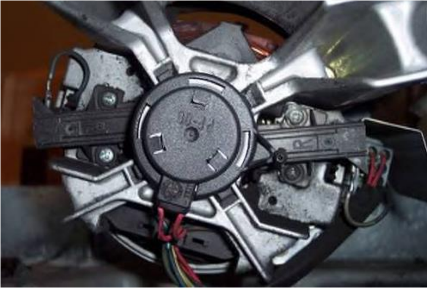
Şekil 1.14 Fırçaların motor üzerindeki montaj hali (Anonim 2015)
