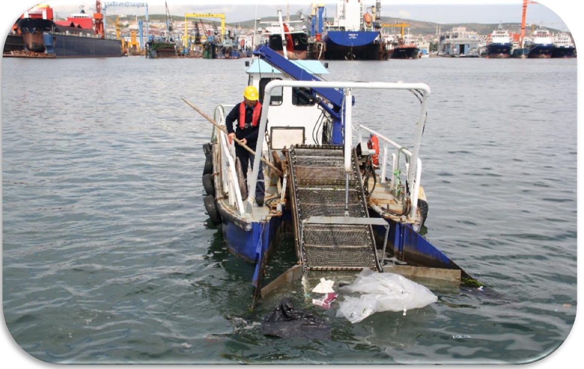
Resim 2.18. Temiz Tuzla Deniz Yüzeyi Temizleme Teknesi (GİSAŞ 2017)
