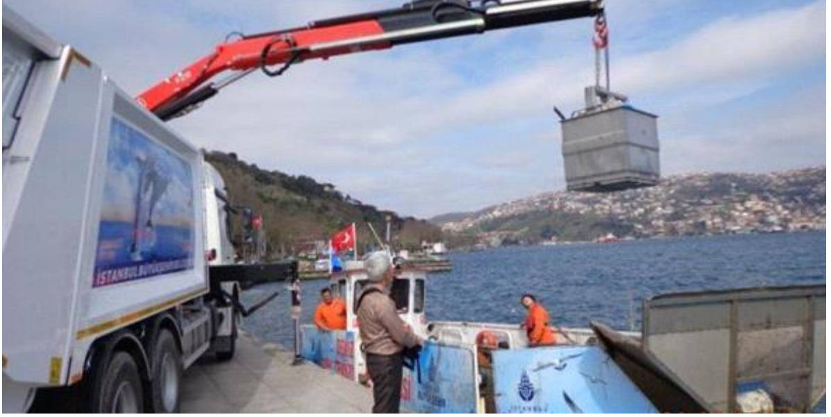
Resim 2.11 Vinçli sıkıştırılmalı atık toplama aracı (İSTAÇ 2016)
