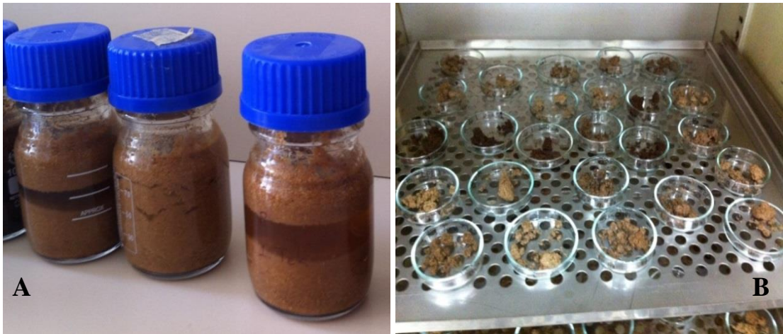
Şekil 3.3.2. A: Ön işlem uygulanmış mısır posası. B: Posadan nem tayini için etüvde kurutulan mısır örnekleri
