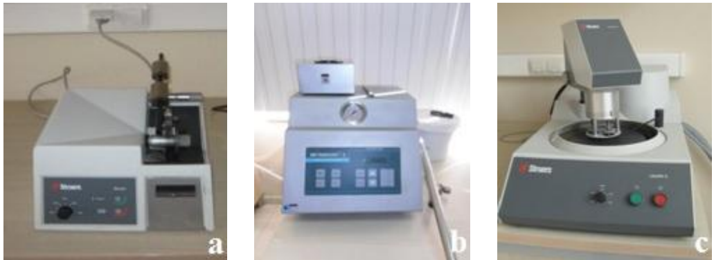
Şekil 3.7. (a) Hassas Kesme Cihazı, (b) Metalografik Kalıplama Cihazı, (c) Yük Kontrollü Hassas Parlatma Cihazı (MKÜ Mikro/Nano Mekanik Karakterizasyon Lab.)
