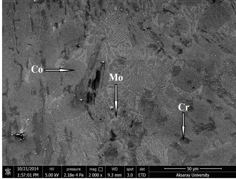
Şekil 4.5. Pd-1 alaşımına ait SEM görüntüleri
