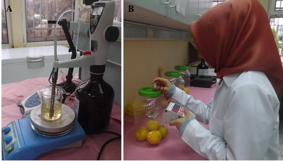
Şekil 3.2. Titre edilebilir asitliğin potansiyometrik yöntem ile ölçülmesi (A) ve meyvelerin CO 2 /O 2 ölçüm cihazı ile CO 2 miktarının belirlenmesi (B).
