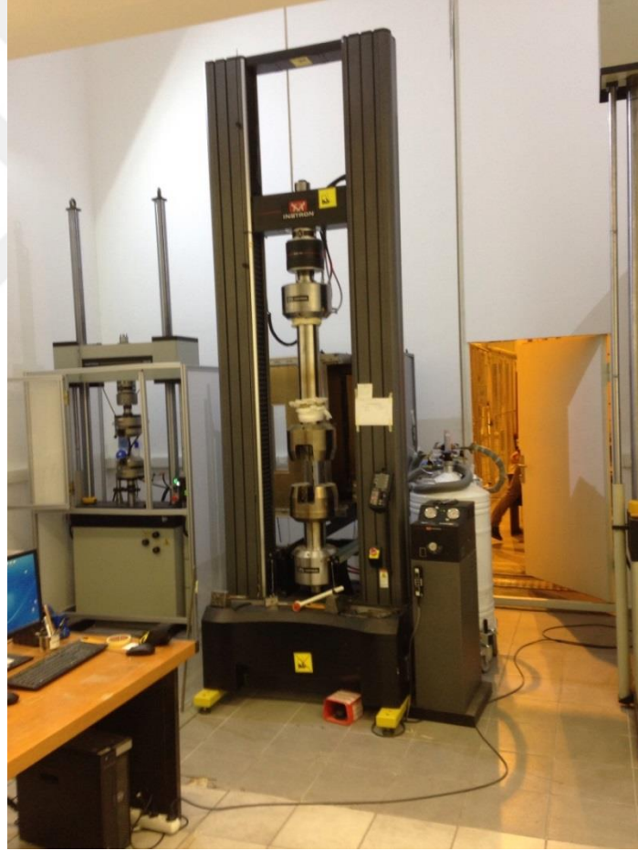
Şekil 4.1 Instron 5985 B10422 Elektro Mekanik Test Cihazı
