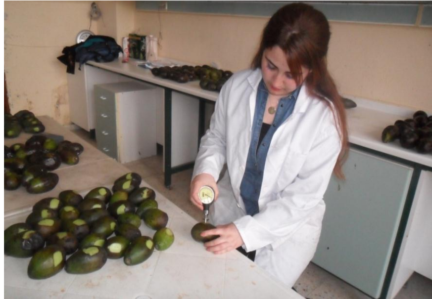
Şekil 3.15. Fuerte ve Zutano avokado çeşitlerine ait meyvelerin penetrometre ile meyve eti sertliğinin ölçülmesi
