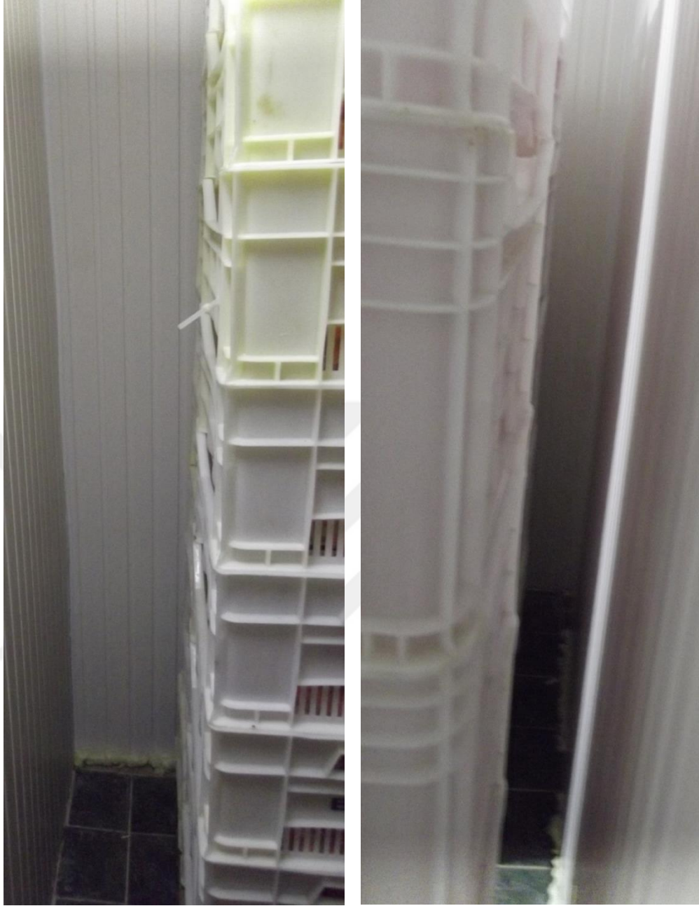
Şekil 3.14. Depoda istifle yan duvarlar arasında bırakılan boşluklar
