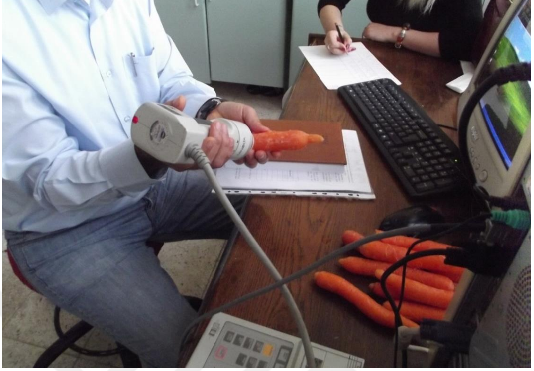
Şekil 3.21. Renk ölçüm cihazı ile havuçların renginin belirlenmesi
