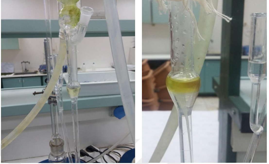
Şekil 3.6. Clevenger cihazı ekstrakt biriktirme üniteleri ve biriken uçucu yağ ekstraktları
