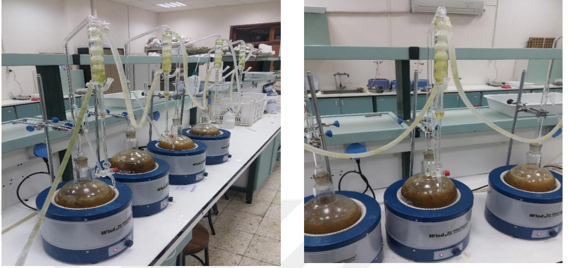
Şekil 3.4. Clevenger cihazında hidrodistilasyon işlemi
