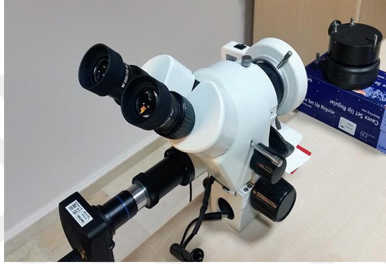
Resim 30: Stereoskopik mikroskop ve ölçümde kullanılan basit düzenek
