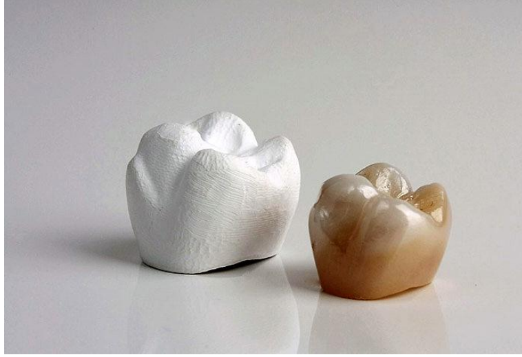
Resim 7: Monolitik zirkonyum kuron üretimi; sinterizasyon öncesi (% 20-25 daha büyük) ve sinterizasyon sonrası (gerçek boyutunda)
