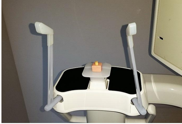
Resim 18: Çalışma modelinin CBCT cihazına yerleştirilmesi
