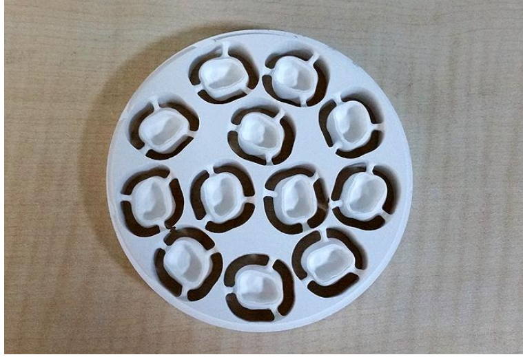
Resim 15: CAM cihazı ile üretimden çıkan monolitik zirkonyum blok
