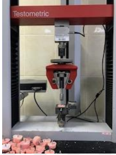
Şekil 3.16 Üniversal test cihazında çekme testinin uygulanması
