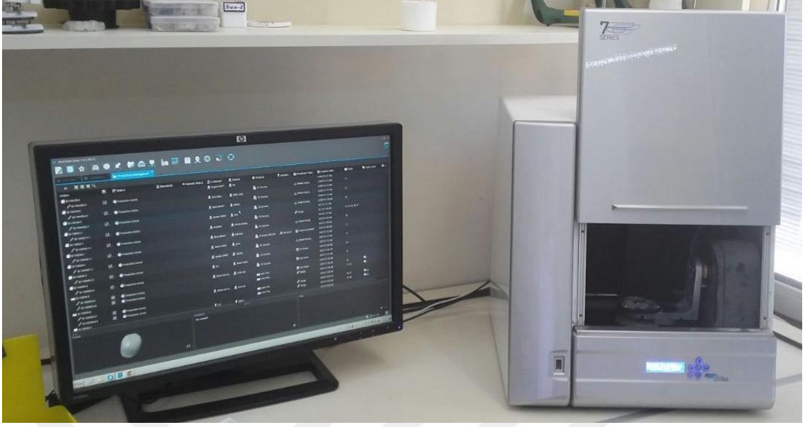
Şekil 3.13 Üç boyutlu tarayıcı ve bağlı olduğu bilgisayar programı
