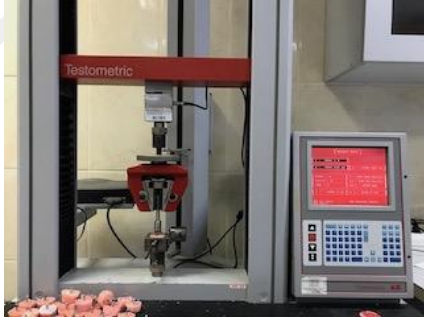
Şekil 3.15 Örneklerin üniversal test cihazına yerleştirilmesi
