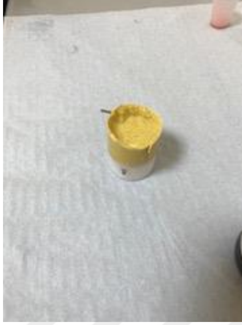
Şekil 3.11 Silikon anahtar içinde bulunan abutmentin akrilik içine yerleştirilmesi
