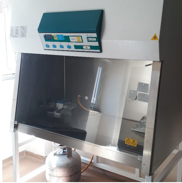
Şekil 3.7. Laminar Flow Kabini (Heal Force, Çin)
