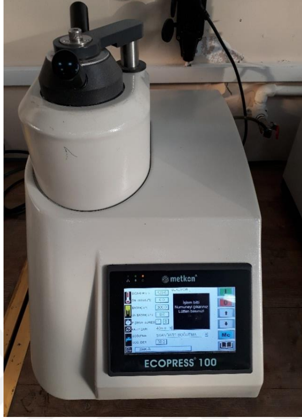
Şekil 3.19. Bakalit blokların yapımında kullanılan ECOPRESS 100 cihazı (Metkon, Türkiye)
