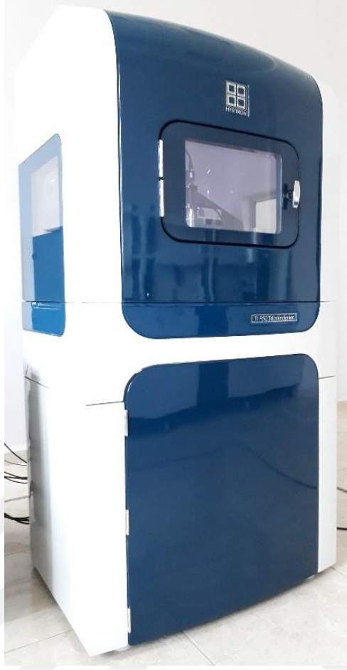
Şekil 3.26. Hysitron TI 950 TriboIndenter cihazı (Hysitron, ABD)
