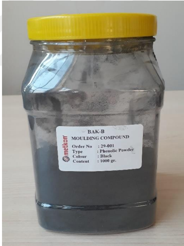
Şekil 3.18. Bakalit blokların yapılmasında kullanılan fenolik toz (Metkon, Türkiye)
