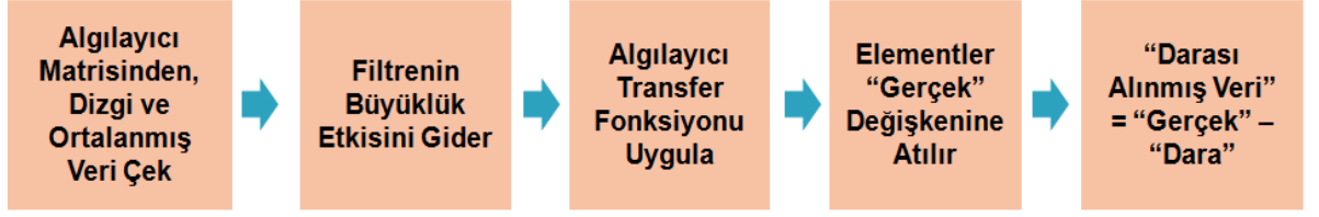
Şekil 7.38 Algılayıcı Verilerinin Büyüklüklerini Etkileyen, Filtre Etkilerinin Giderilmesi, Voltajdan Kuvvete Çevrilmesi için Akış Şeması
