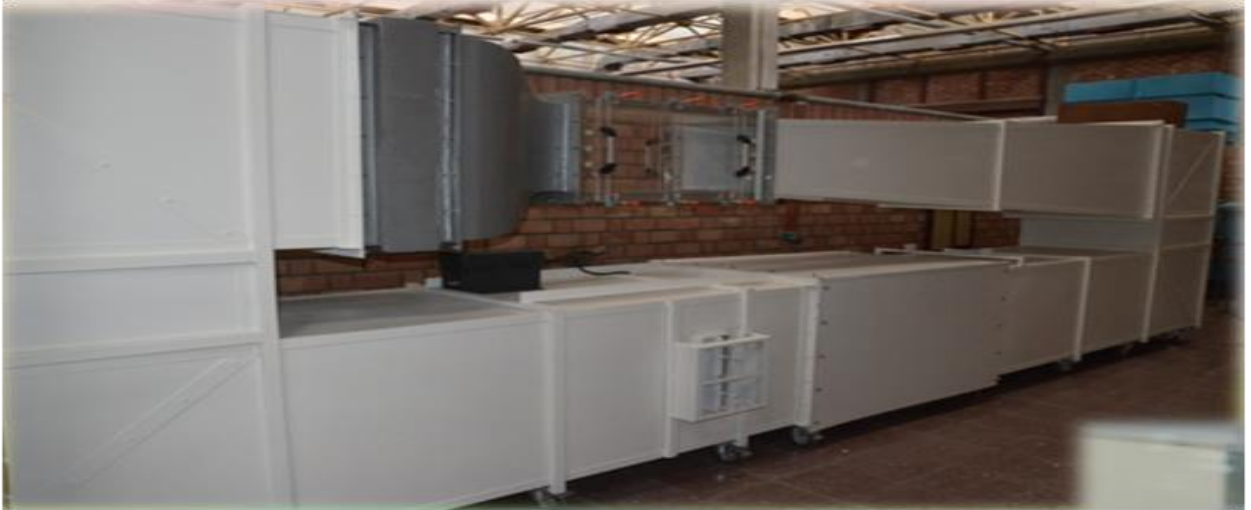
Şekil 1.1 Kapalı Çevrim, Ses Altı Rüzgâr Tüneli 1
