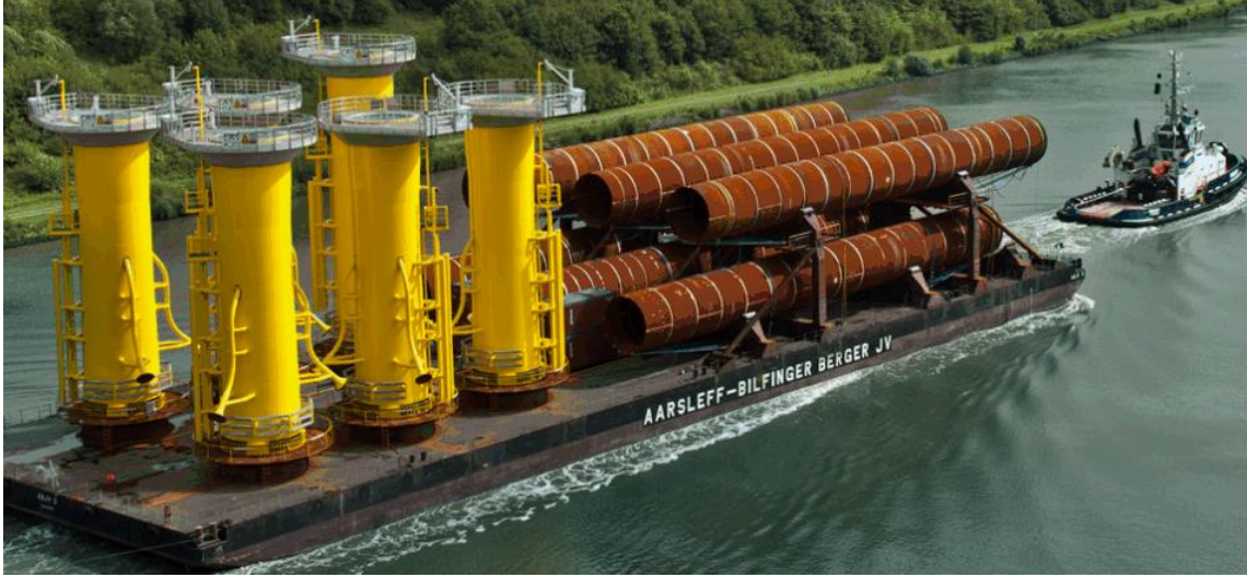
Şekil 3.3 Tek kazık temel için çakılacak olan çelik boruların ve dış kılıfların taşınması[26]
