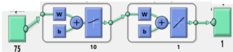
Şekil 3. 19 : Kullanılan Ağ Yapısındaki Ara Katmanlar ve Fonksiyonlar
