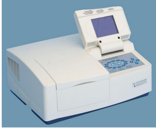
Şekil 3.3. Çalışmada kullanılan PG Instrument T-70 model UV-VIS Spektrofotometre
